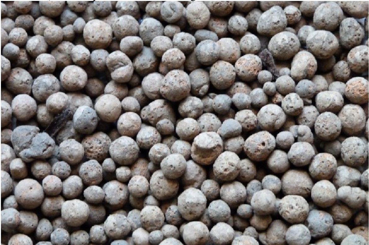
ARLITA (arcilla expandida de diferente granulometría)
